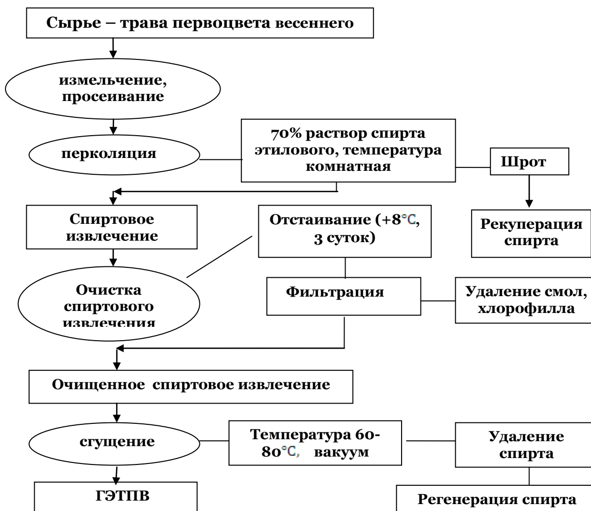
Рис. Схема основных стадий получения ГЭТПВ
