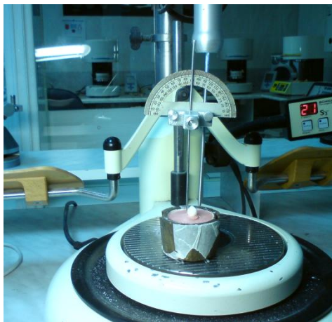
Рис. 2. Кювета с зубом и устройство, используемое для корректной препаровки зуба
